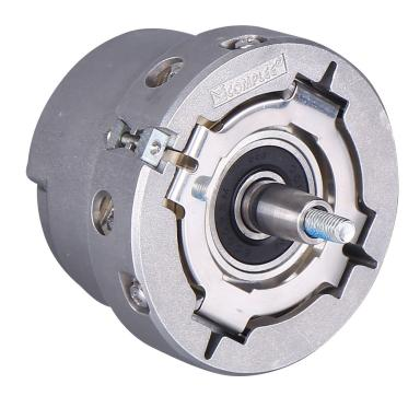
重载型编码器的使用场合:重载型编码器是专门应对各种重工业以及各类轴重负载的使用场合,具有良好的抗机械损伤功能,并在轴上能承受较高的径向和轴向负荷,能够直接安装在驱动轴上,键槽衔接。由于冶金、造纸和港口机械等重载职业环境恶劣,具有高温高湿、油污粉尘、冲击和振动非常大的特点。传统的光电编码器,从工作原理上受到玻璃码盘的限制,大的冲击和振动可能形成码盘的破碎;假如密封欠好,水、粉尘和油污等污染物也会进入编码器内部形成编码器失效。而重载使用场合,一般24小时接连运转,要求高牢靠性,编码器作为重心反应器件,一旦呈现故障会形成整个设备乃至出产线的停工,由此形成非常巨大的丢失。因而,重载型编码器特别适合冶金,造纸,木工机械,重型机械等职业的使用。为了习惯更严苛的工业环境,重载型编码器专门被研制出来。与传统的工业编码器比较,重载编码器具有更强的抗冲击和震动的能力,它们的外壳也能够习惯各种恶劣的环境。
