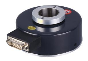
伺服电机编码器介绍:伺服电机编码器是安装在伺服电机上用来测量磁极位置和伺服电机转角及转速的一种传感器,从物理介质的不同来分,伺服电机编码器可以分为光电编码器和磁电编码器,另外旋转变压器也算一种特殊的伺服编码器,市场上使用的基本上是光电编码器,不过磁电编码器作为后起之秀,有可靠,价格便宜,抗污染等特点,有赶超光电编码器的趋势。伺服电机编码器轴与机器的连接,应使用柔性连接器。另一种正余弦编码器除了具备上述正交的sin□cos信号外,还具备一对一圈只出现一个信号周期的相互正交的1Vp-p的正弦型C□D信号,如果以C信号为sin□则D信号为cos□通过sin□cos信号的高倍率细分技术,不仅可以使正余弦编码器获得比原始信号周期更为细密的名义检测分辨率,比如2048线的正余弦编码器经2048细分后,就可以达到每转400多万线的名义检测分辨率;此外带C□D信号的正余弦编码器的C□D信号经过细分后,还可以提供较高的每转位置信息,比如每转2048个位置,因此带C□D信号的正余弦编码器可以视作一种模拟式的单圈绝对编码器。上海电梯编码器如何使用?陕西质量旋转编码器哪里买
