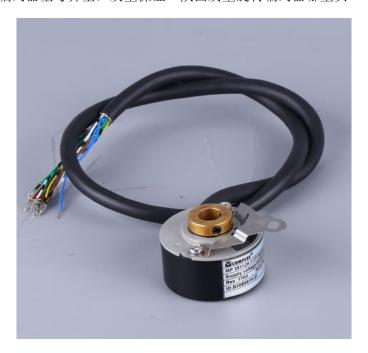
康比利教你如何使用增量编码器? 1,增量型旋转编码器有分辨率的差异,使用每圈产生的脉冲数来计量,数目从6到5400或更高,脉冲数越多,分辨率越高;这是选型的重要依据之一。2,增量型编码器通常有三路信号输出(差分有六路信号□□A,B和Z□一般采用TTL电平□A脉冲在前□B脉冲在后□A,B脉冲相差90度,每圈发出一个Z脉冲,可作为参考机械零位。一般利用A超前B或B超前A进行判向,增量型编码器定义为轴端看编码器顺时针旋转为正转□A超前B为90°,反之逆时针旋转为反转B超前A为90°。也有不相同的,要看产品说明。3,使用PLC采集数据,可选用高速计数模块;使用工控机采集数据,可选用高速计数板卡;使用单片机采集数据,建议选用带光电耦合器的输入端口。4,建议B脉冲做顺向(前向)脉冲□A脉冲做逆向(后向)脉冲□Z原点零位脉冲。5,在电子装置中设立计数栈。陕西质量旋转编码器哪里买上海旋转编码器采购报价。
